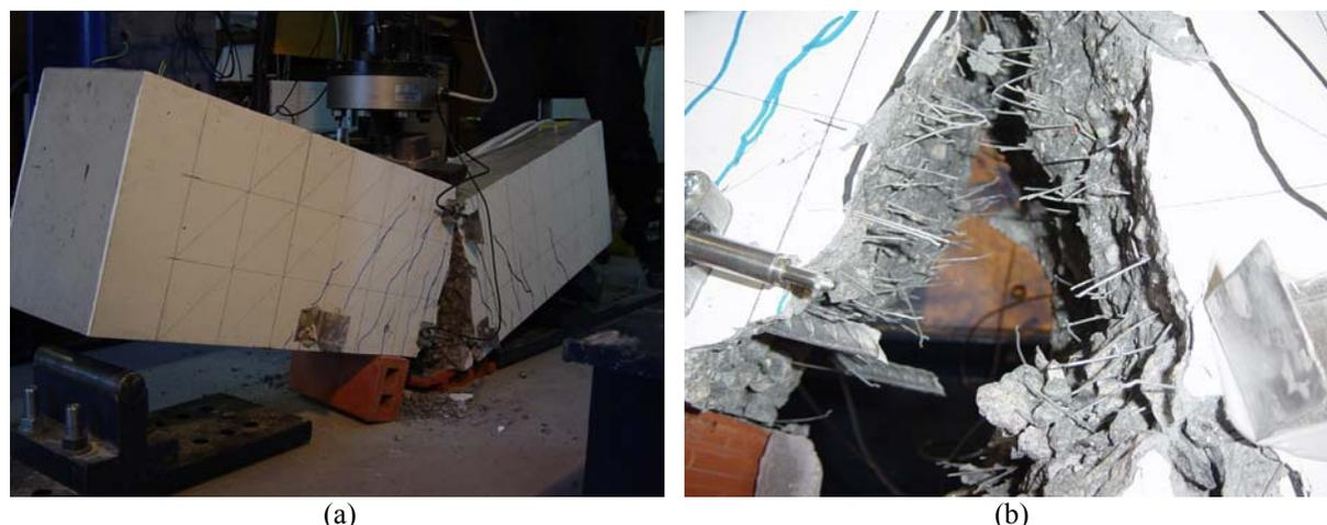
Figura 13 - (a) Aspecto da viga S2\_6 na rotura e (b) distribuição das fibras na secção de fractura.
