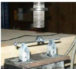
Figura 8 - Esquema de ensaio utilizado no ensaio à flexão do parafuso (cm)
