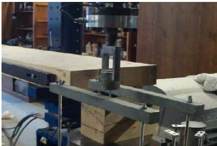
Figura 6 - Esquema de ensaio utilizado no arrancamento do parafuso
