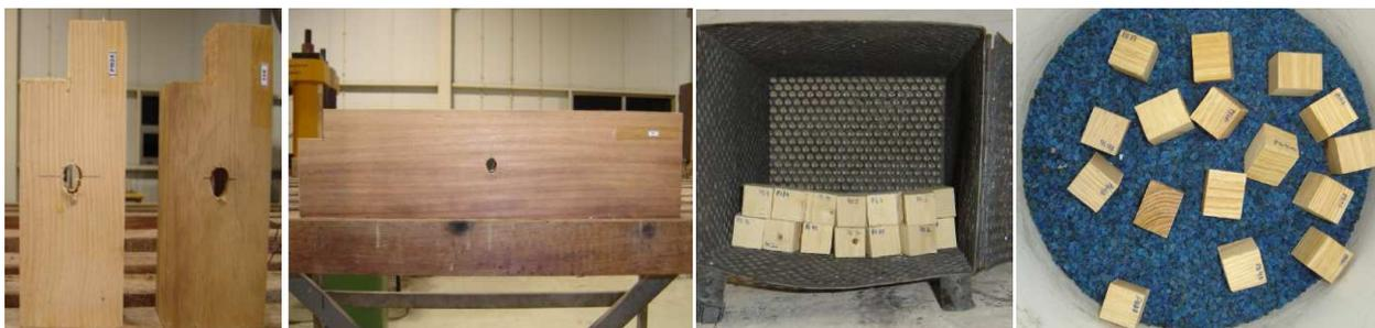
Figura 3 – Principais passos efectuados para a quantificação da massa volúmica ( $\rho$ ) e teor de água ( $w$ ) dos provetes usados na avaliação do esmagamento localizado da madeira ( $f_h$ )
