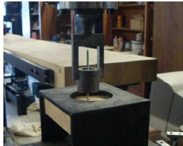
Figura 7 - Esquema de ensaio utilizado no atravessamento da cabeça do parafuso
