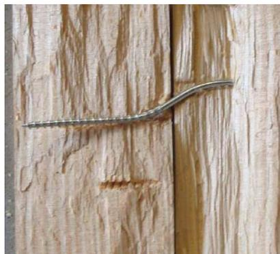
Figura 14 – Modo de rotura típico das ligações ensaiadas, onde é perceptível o esmagamento das duas peças de madeira e a plastificação do parafuso
