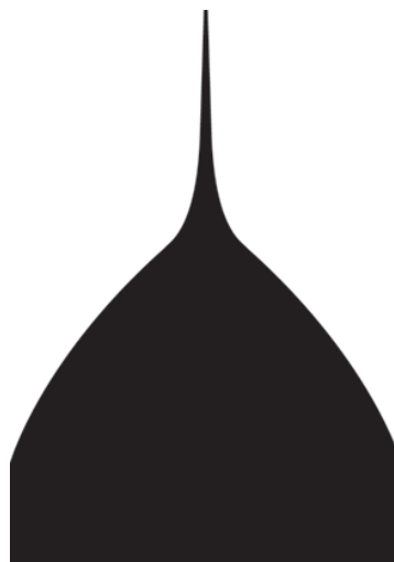
Figura 4.3 - Cone de Taylor formado por glicerina (98%) e 2% de uma solução de NaCl a 10% com um tempo de exposição de 1 ms (Stanger, 2005).
