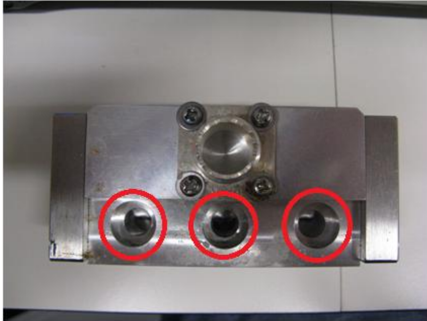
Figura 4.13 - Exemplo de modificação: este suporte apresenta três apoios para três orifícios de projeção da solução polimérica distintos.
