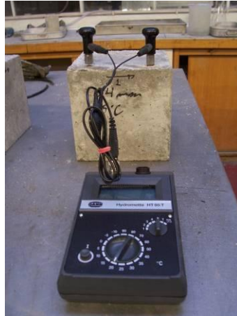
Figura 1. Medição do teor de humidade de um provete de betão recorrendo a um higrómetro.
