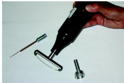
**Figura 15:** Equipamento de corona portátil (modelo BD20-AC) com eletrodos destacáveis. Electro-Technic Products, Inc [25].
