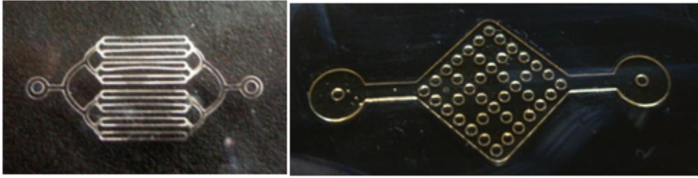
**Figura 23:** Exemplos de moldes em SU-8 com diferentes geometrias.
