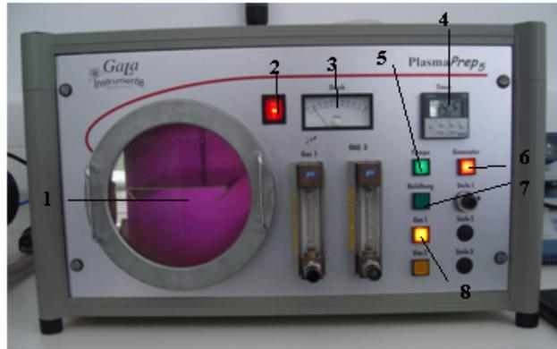
**Figura 30:** Equipamento utilizado para gerar Plasma de Oxigénio. O equipamento é constituído por: 1) câmara de reação em aço inoxidável; 2) Botão de ligar/desligar o equipamento; 3) Indicador de pressão; 4) Temporizador; 5) Botão de ligar/desligar a bomba de vácuo; 6) Botão de ligar/desligar o gerador de plasma; 7) Botão de ventilação e; 8) Botão de abrir/fechar válvula do gás.
