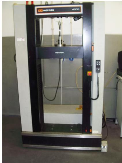
**Figura 35:** Equipamento utilizado nos testes de tração da marca Instron 4505.
