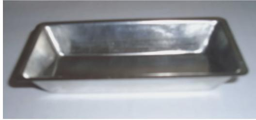
**Figura 25:** Forma de alumínio usada no processo de fabrico do PDMS.
