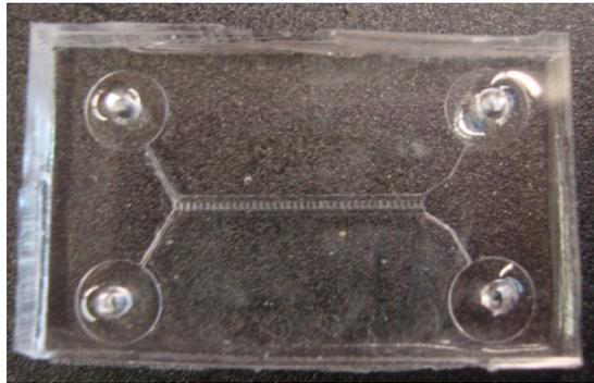
**Figura 33:** Exemplo de um dispositivo em PDMS fechado por cura parcial.
