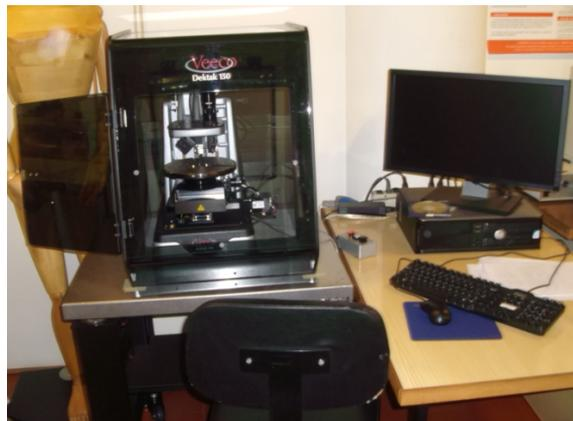
**Figura 45:** Perfilómetro “Dektak 150 Surface Profiler” utilizado na medição das estruturas de PDMS.
