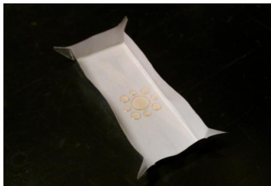
**Figura 24:** Caixa com fita de alumínio contendo o molde em SU-8.
