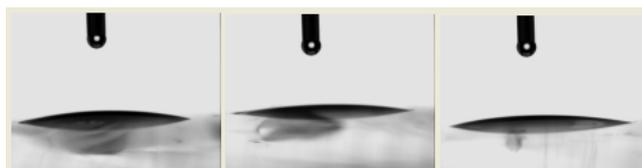
**Figura 51:** Imagem do perfil da gota numa amostra de PDMS tratada com plasma de oxigénio passados 60 min nas três medições.
