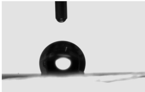
**Figura 41:** Imagem do perfil de uma gota séssil numa amostra de PDMS sem tratamento, evidenciando um elevado ângulo de contacto.
