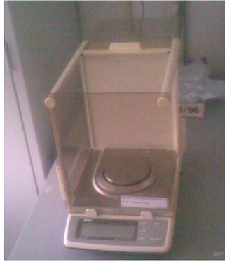
**Figura 27:** Balança de precisão da marca AND modelo HR-120.
