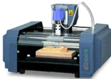
**Figura 8:** Equipamento de microfresagem (Roland MDX-20).
