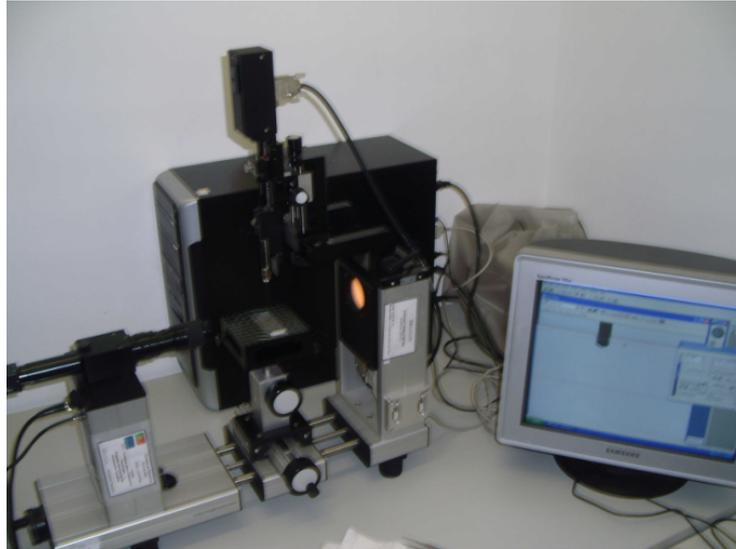
**Figura 40:** Sistema de medição do ângulo de contacto.
