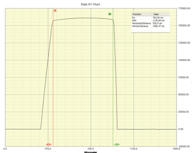
**Figura 54:** Perfil do molde em SU-8 utilizado para o fabrico da estrutura em PDMS.
