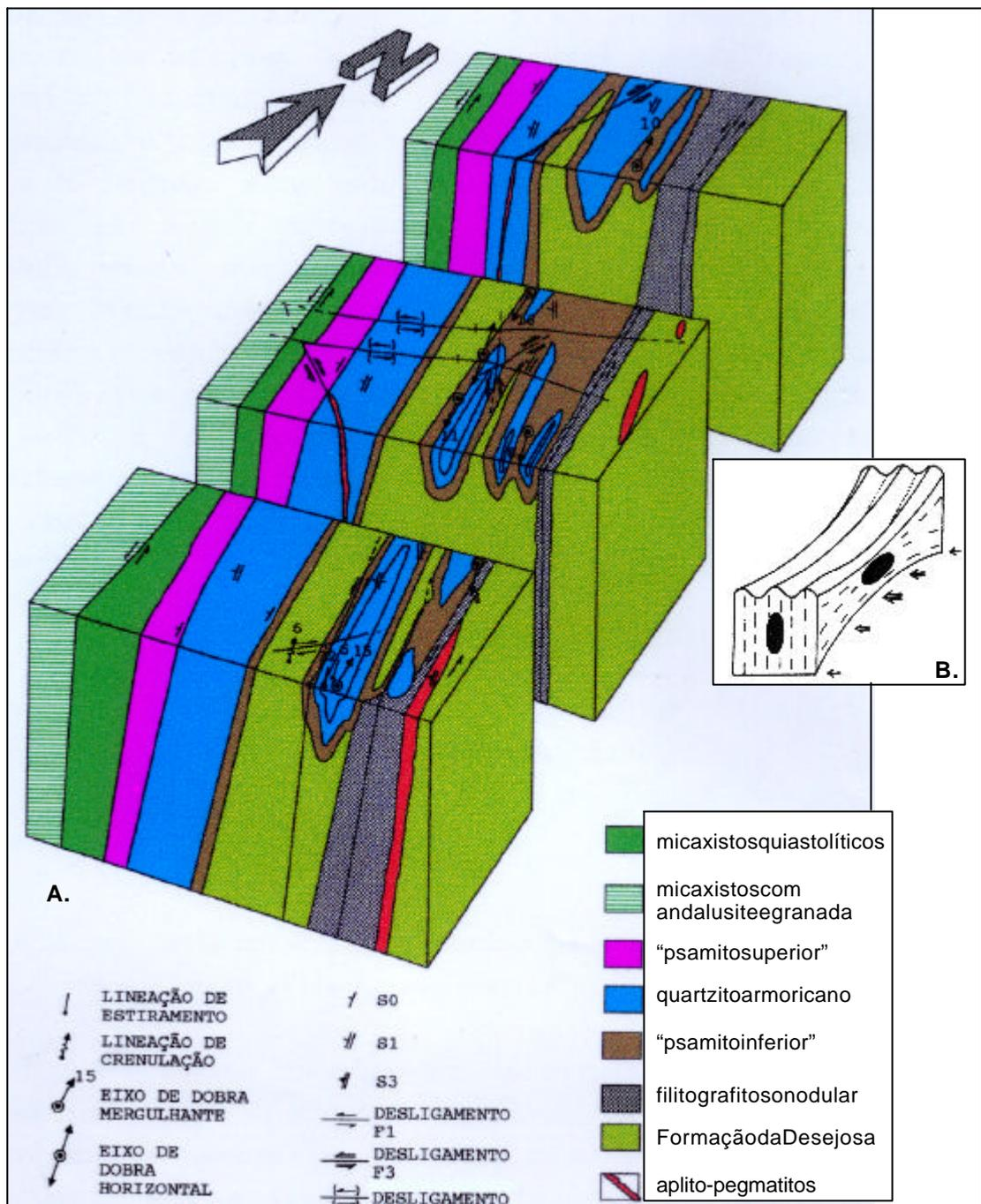
Figura.IV.10-A.BlocoesquemáticomostrandoE, ondulantes,poracção dumcorredordecisalhamento sinestrógiro. Também seobservam desligamentosde distintas fases. B.Achatamento diferencial ao longodosplanosaxiaisdadobras,comformação deeixosondulantes.Adaptado dePamplona(1994)e Dias&Ribeiro(1994)..
