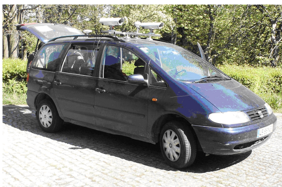
Figura 1. Carrinha modificada utilizada como Sistema Móvel de Mapeamento.
