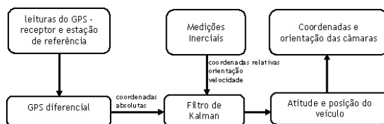
Figura 2. Integração do sensores de georeferenciação.
