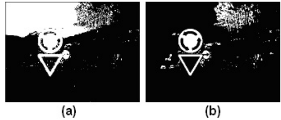
Figura 6. Segmentação Hue/Saturação versus Hue/componente cromático.
