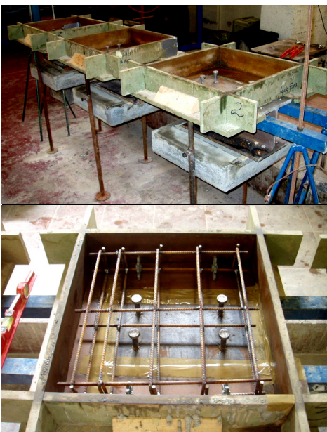
Fig. 2 – Preparação dos moldes para a betonagem
