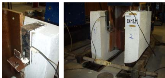
Fig. 3 – Montagem final do provete e pormenores de colocação dos transdutores
