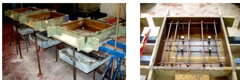
Fig. 2 – Esquema de realização da betonagem
