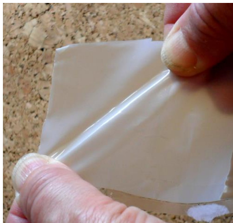
Fig. 5.4. Teste de avaliação da flexibilidade do filme Mater-bi® NF01U recoberto por verniz aquoso da marca CIN.
