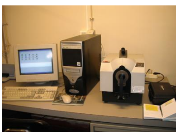
Foto 3. Espectrofotómetro de reflectância, Datacolor International DF 600 Plus Dept. Eng. Têxtil, Universidade do Minho
