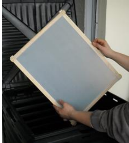
Fig. 3.10. Imagem de uma estrutura de madeira para fixação com uma amostra de filme polimérico.
