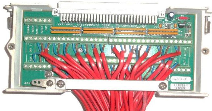
Figura 4.9 – Forma de ligar os termopares ao bloco de terminais SCXI-1303.
