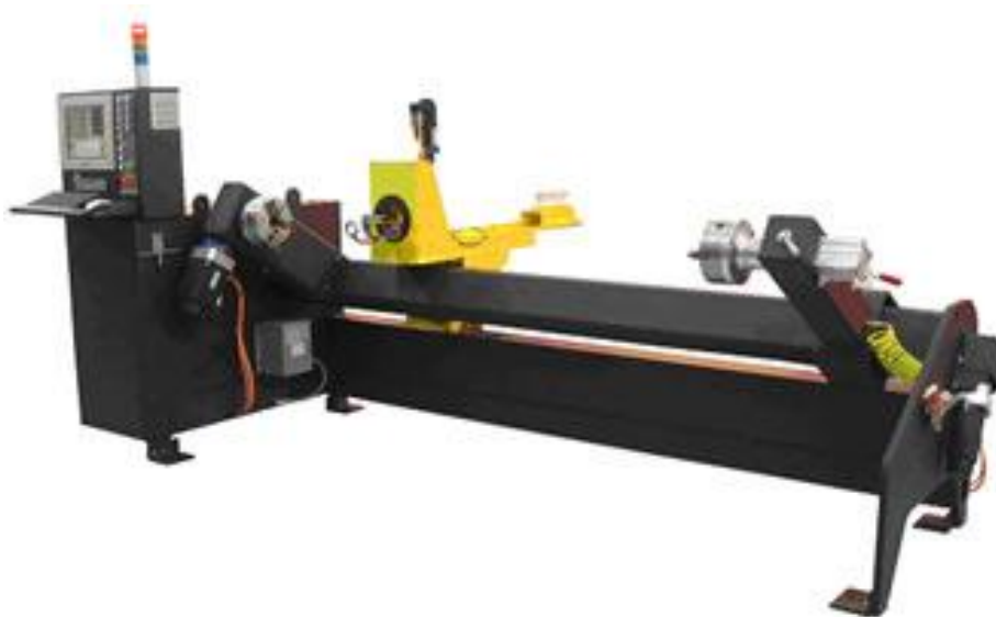
Figura 3 – Exemplo de equipamento de enrolamento filamentar.
