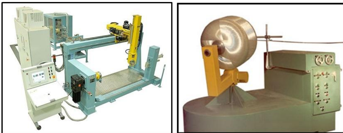
Figura 5 – a) disposição lathe winder b) disposição tumble winder
