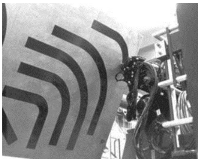
Figura 2.7 – Sistema AFP, com aplicação de fibra com variações localizadas de orientação [61]
