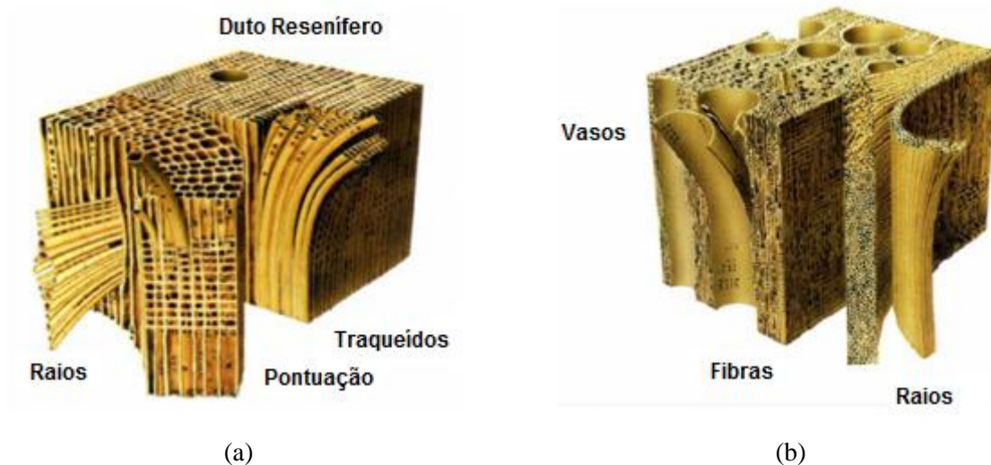
Figura 5 – Estrutura microscópica da madeira: (a) coníferas; e (b) folhosas [adaptado de (Stamato & Góes, s.d.)]
