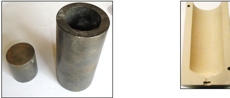
Figura 4.2 – Moldação permanente utilizada nos ensaios.
