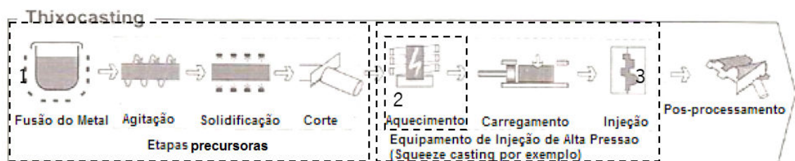
Figura 2.5 – Etapas do processo de Thixocasting . (Adaptado de [11])
