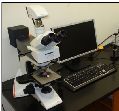
Figura 4.5 – Microscópio ótico com capacidade de gravação das imagens observadas.
