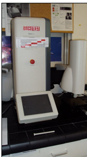
Figura 4.7 – Equipamento para a realização das indentações do ensaio de durezas – Modelo DURASCAN da marca EMCOTEST .
