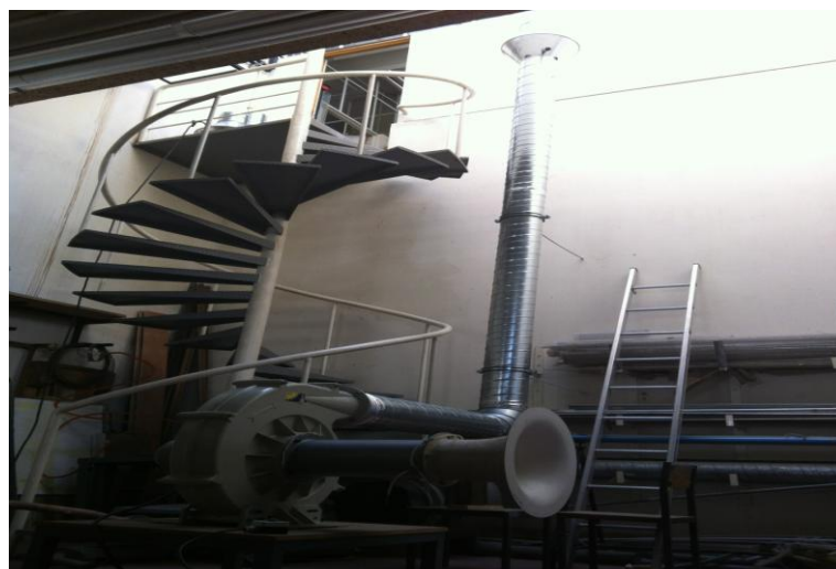
Figura 3-3: Instalação Experimental do Chapéu Descarga Vertical
