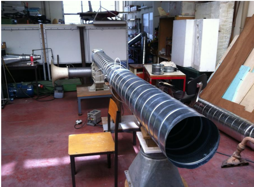
Figura 3-4: Instalação experimental do Registo Regulador de Caudal
