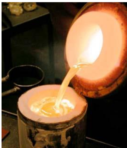
Figura 7 – Vazamento de moldações cerâmicas em carapaça (adaptado [6]).
