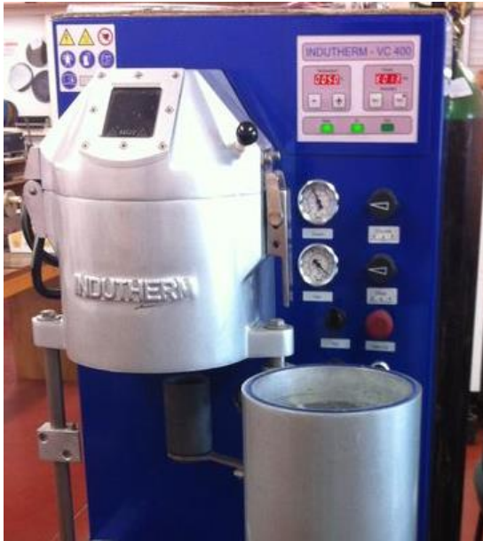
Figura 48 – Cadinho utilizado nas atividades experimentais e respectivas características, Indutherm VC-400.
