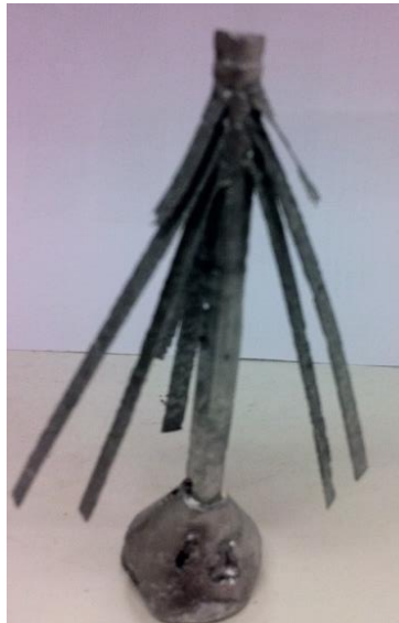
Figura 54 - Fundido obtido no terceiro ensaio experimental da liga de alumínio.
