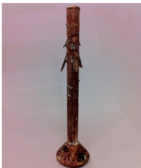
Figura 64 - Fundido obtido no quarto ensaio experimental da liga de cobre estanho.
