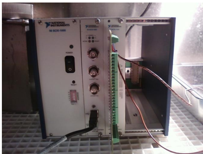
Figura 31 – Placa eletrónica de aquisição de dados da temperatura no interior da caixa (adaptado [19]).
