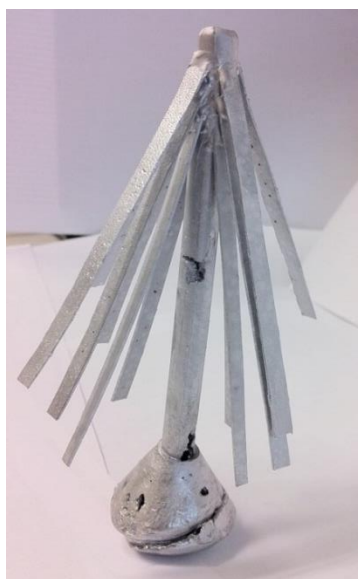
Figura 50 – Fundido obtido no primeiro ensaio experimental da liga de alumínio.
