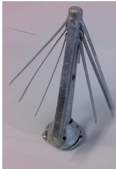
Figura 52 - Fundido obtido no segundo ensaio experimental da liga de alumínio.
