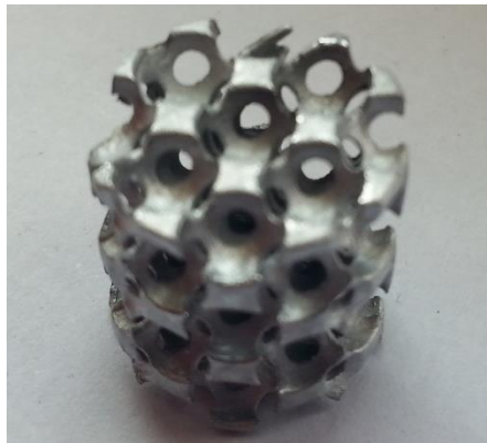
Figura 1 – Estrutura celular de alumínio obtida através do vazamento em moldação cerâmica.
