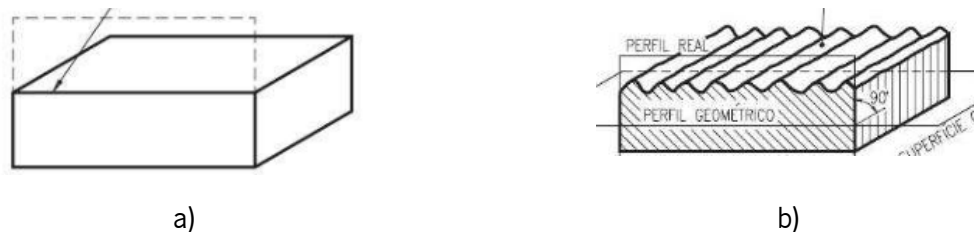
Figura 14 – Avaliação dos tipos de perfis de forma a definir a avaliação do estado de superfície. a) Perfil geométrico; b) Perfil real; (adaptado [12]).
