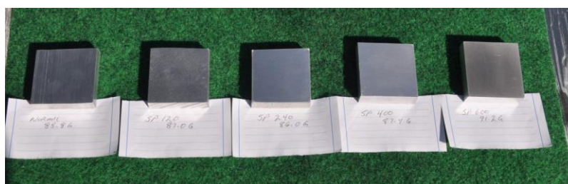
Figura 30 – Amostras de teste: Normal, SP120, SP240, SP400, SP600, respetivamente (adaptado [19]).
