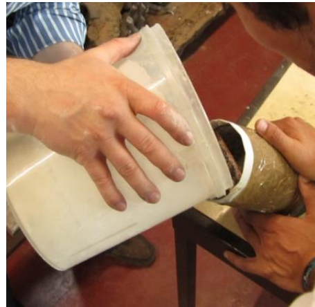
Figura 45 – Gesso de paris a ser introduzido na estrutura de moldação.
