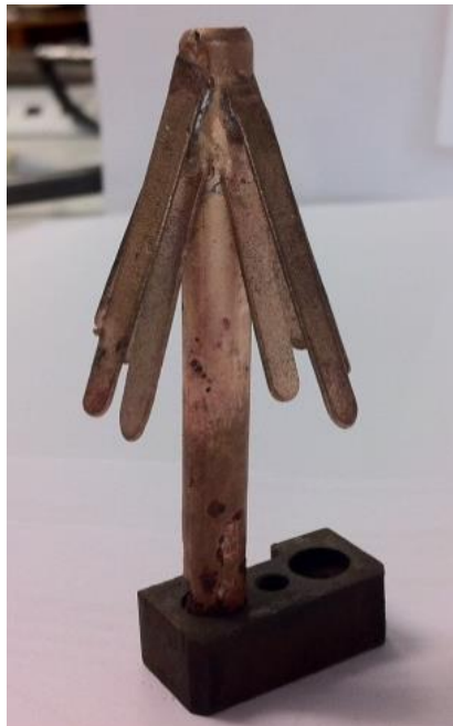
Figura 58 - Fundido obtido no primeiro ensaio experimental da liga de cobre estanho.
