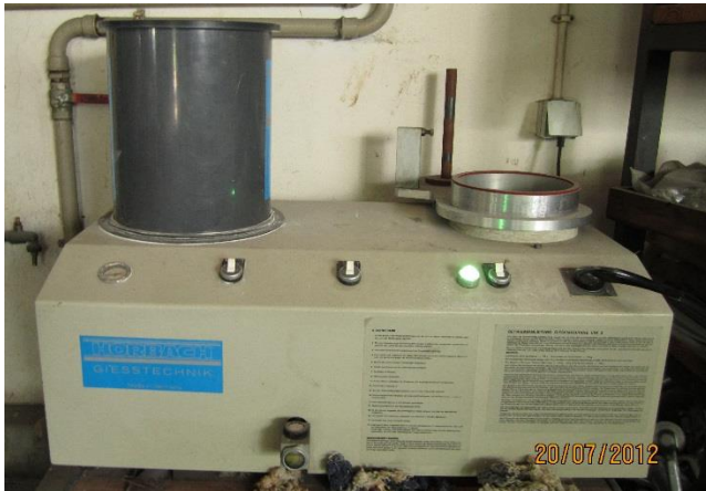
Figura 44 – Equipamento responsável por garantir o vácuo e pressurização do gesso.
