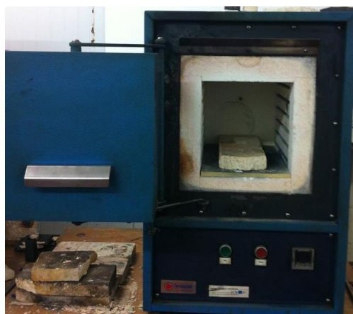
Figura 46 – Forno de alta resistência mais conhecido como mufla.
