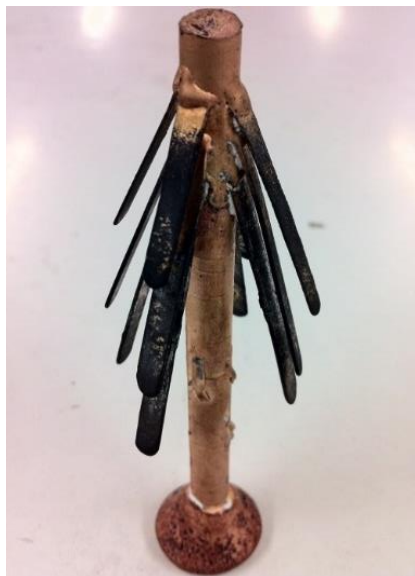
Figura 60 - Fundido obtido no segundo ensaio experimental da liga de cobre estanho.
