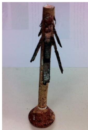
Figura 62 - Fundido obtido no terceiro ensaio experimental da liga de cobre estanho.
