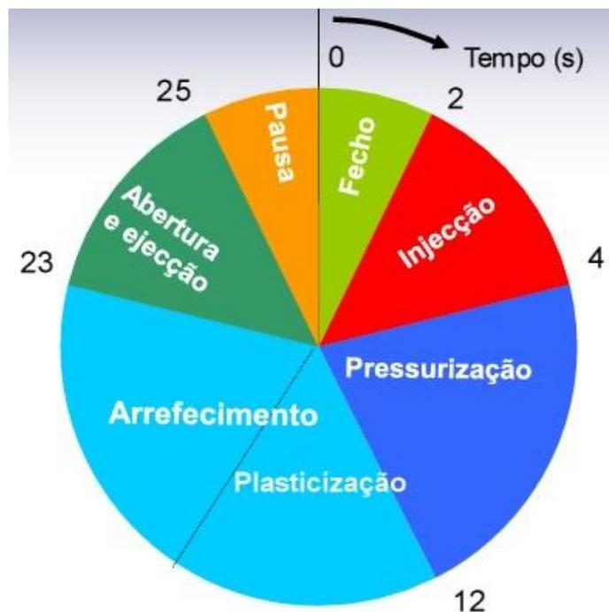
Figura 14. Tempo de Duração das várias etapas da Injeção em Moldes (15).
