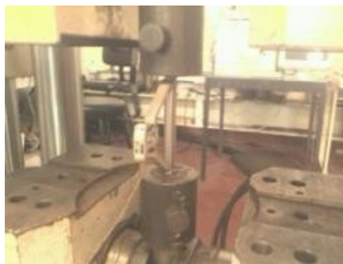
Figura 4.11. Ensaio à tração: secção 40x40 mm
