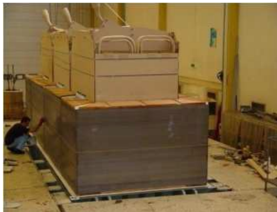
Figura 2.7. Montagem do circuito magnético[15]
