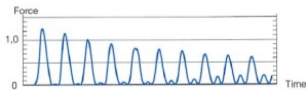
Figura 3.4. Força de curto-circuito e função do tempo [23]
