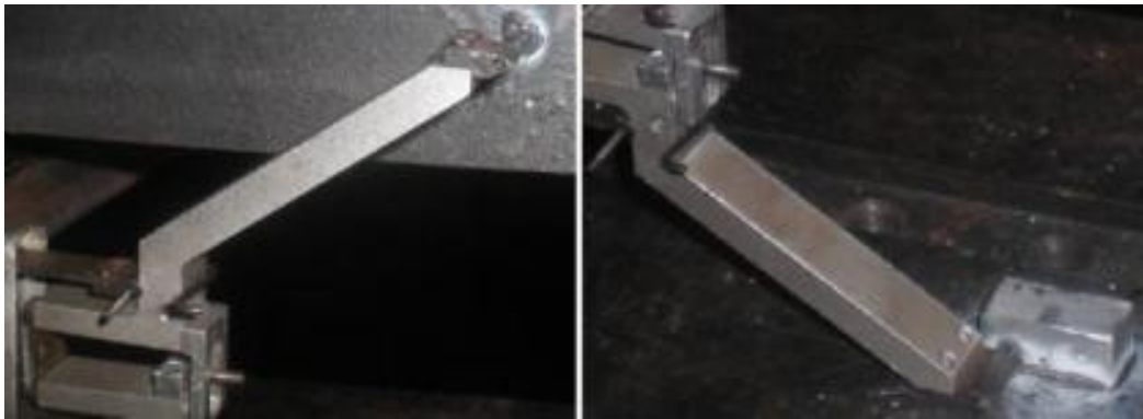
Figura 4.14. Pormenor da fixação do extensómetro no ensaio à flexão
