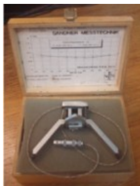
Figura 4.7. Extensómetro mecânico SANDNER modelo EXA 100-10 [19]
