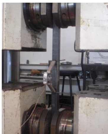
Figura 4.15. Ensaio à tração: secção 20x20
