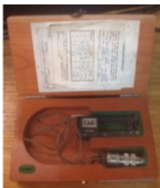
Figura 4.8. Extensómetro mecânico MTS modelo 632 12C-20 [19]
