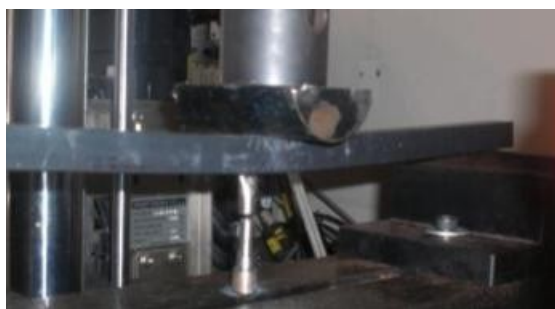
Figura 5.1. Deformação final da viga simplesmente apoiada
