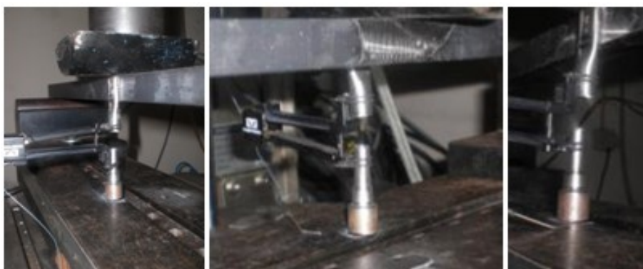
Figura 4.17. Pormenor da fixação do extensómetro mecânico
