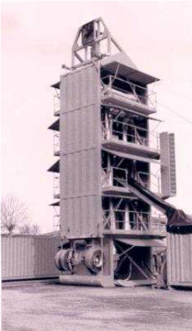
*Figura 2.1: Instalação semi-móvel de produção de pozolanas por calcinação instantânea (Salvador, 2000)*
