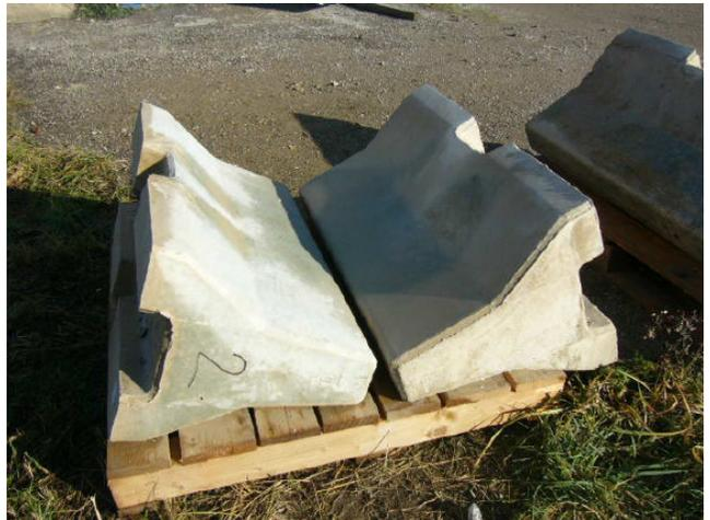
Kumar *et al.* (2005) referem o desenvolvimento de mosaicos, azulejos e de blocos de pavê com recurso a estes materiais. Outros autores confirmam a utilização de betões activados alcalinamente no fabrico de blocos de pavê (Dolezal *et al.*, 2007) (Figura 5.5).
