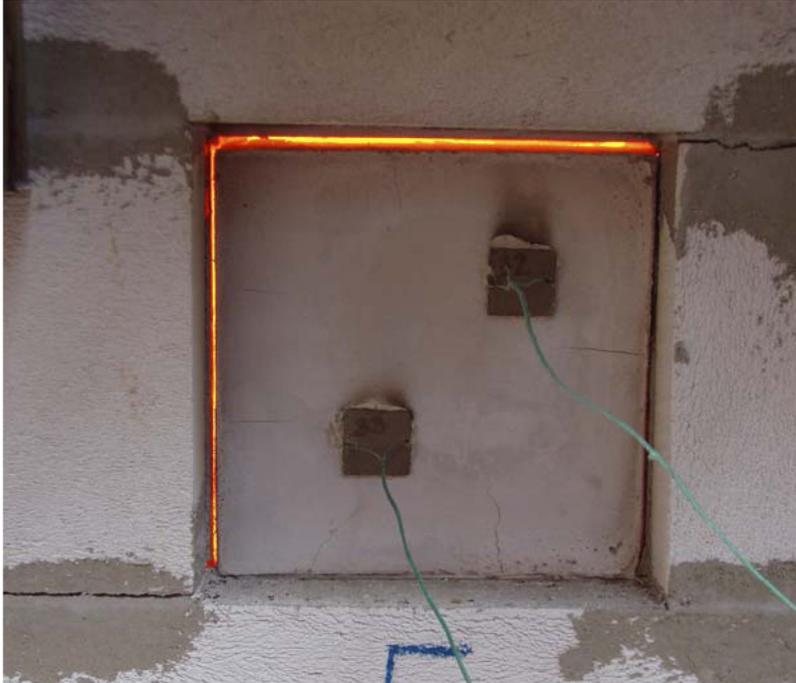
*Figura 4.6: Placas obtidas por activação alcalina sujeitas a fase térmica. São visíveis dois termopares aplicados na face posterior da placa (Perna et al., 2007)*
