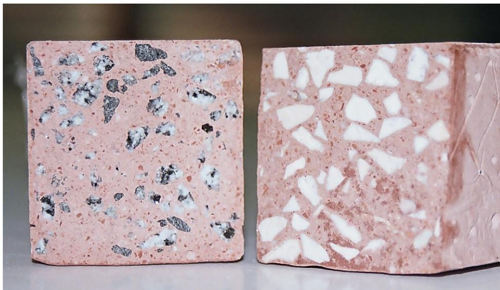
*Figura 6.7: Secção de provete de argamassa AALRM após ensaio de flexão*
