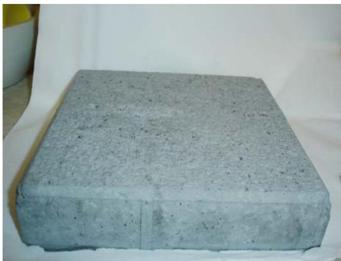
*Figura 5.5: Blocos de pavê em betão activado alcalinamente (Dolezal et al., 2007)*
