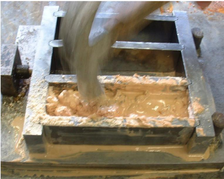
*Figura 3.1: Moldagem de ligante à base de metacaulino activado lcalinamente, com recurso a martelo (Pinto, 2004)*
