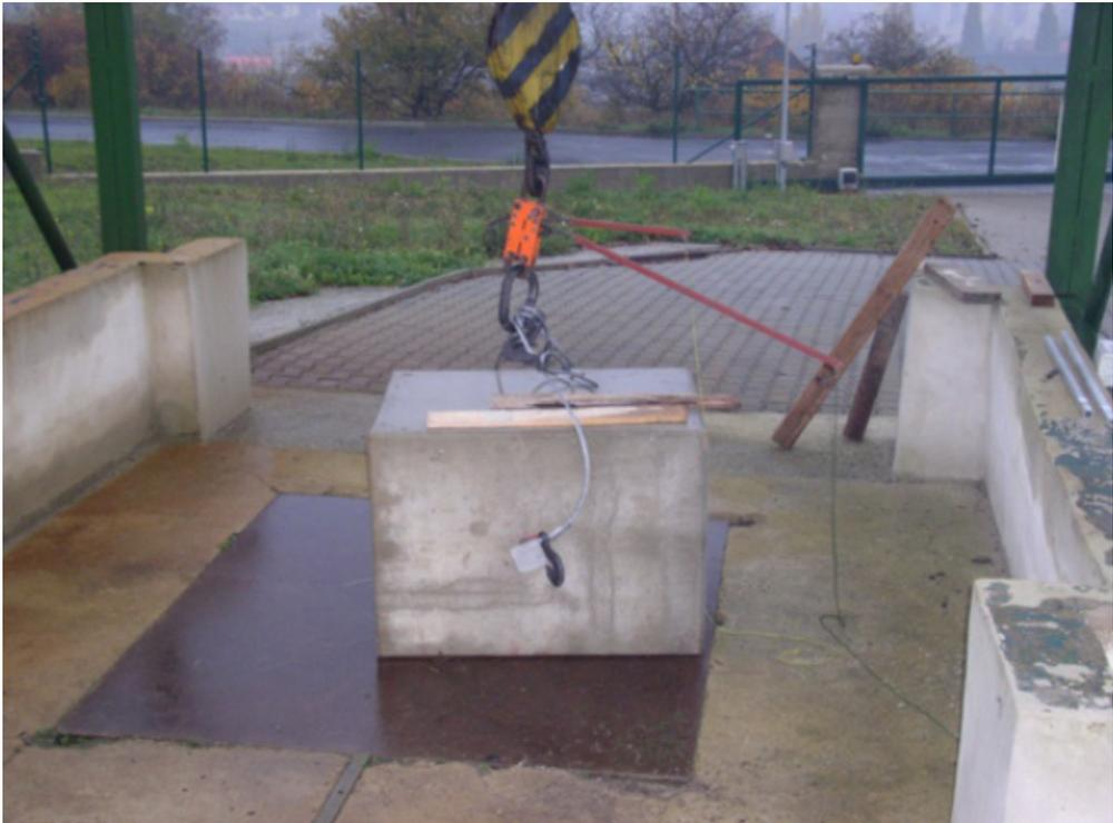
*Figura 5.6: Ensaio de impacto por queda (Mokhort et al., 2007)*
