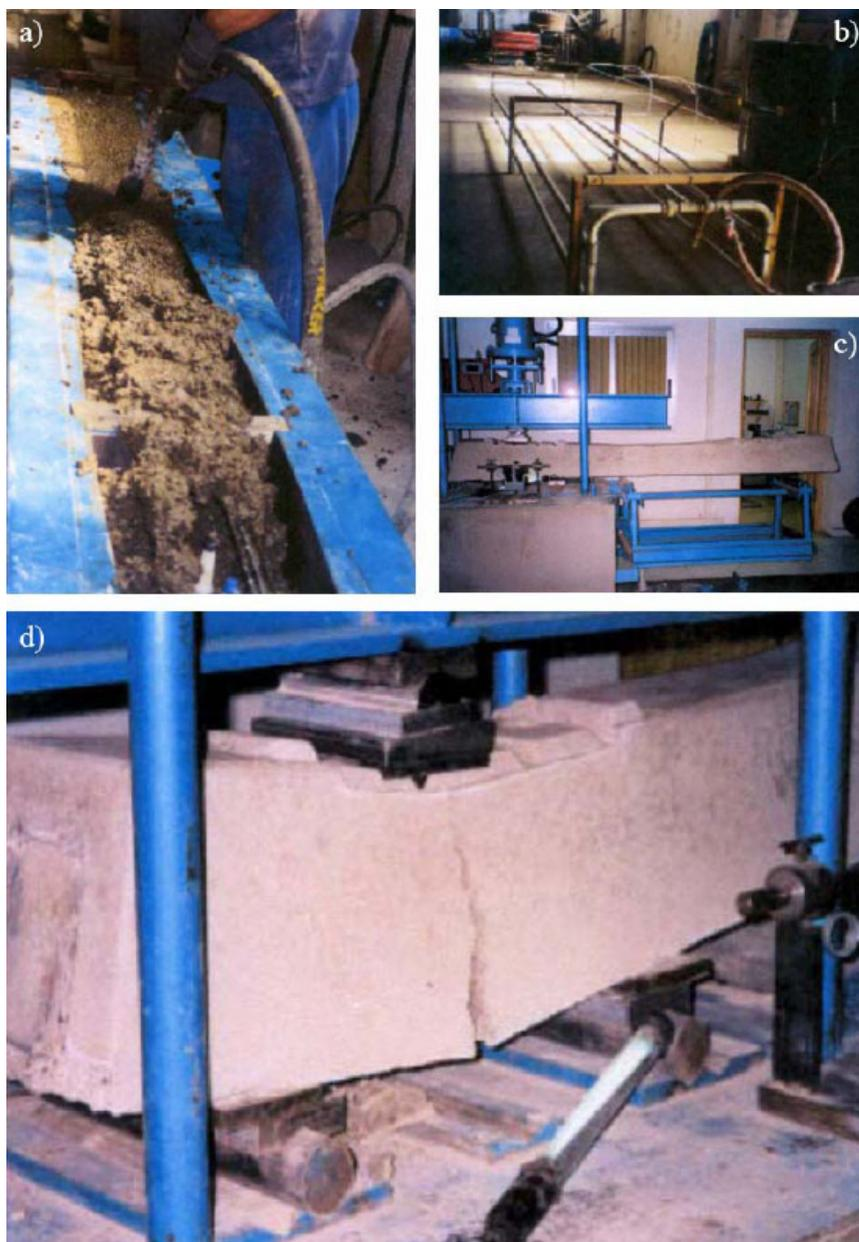
**Figura 5.2:** Travessa para linha ferroviária em betão geopolimérico pré-fabricado à base de cinzas volantes: a) Betonagem e vibração; b) Dispositivo de cura com vapor de água; c) Ensaio de flexão; d) Pormenor da rotura em flexão (Fernandez-Jimenez e Palomo, 2002)
