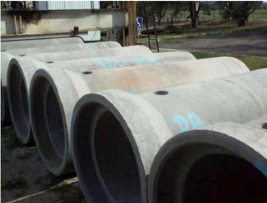
*Figura 5.1: Manilhas de 1500 mm de diâmetro para redes de águas residuais (Gourley e Johnson, 2005)*
