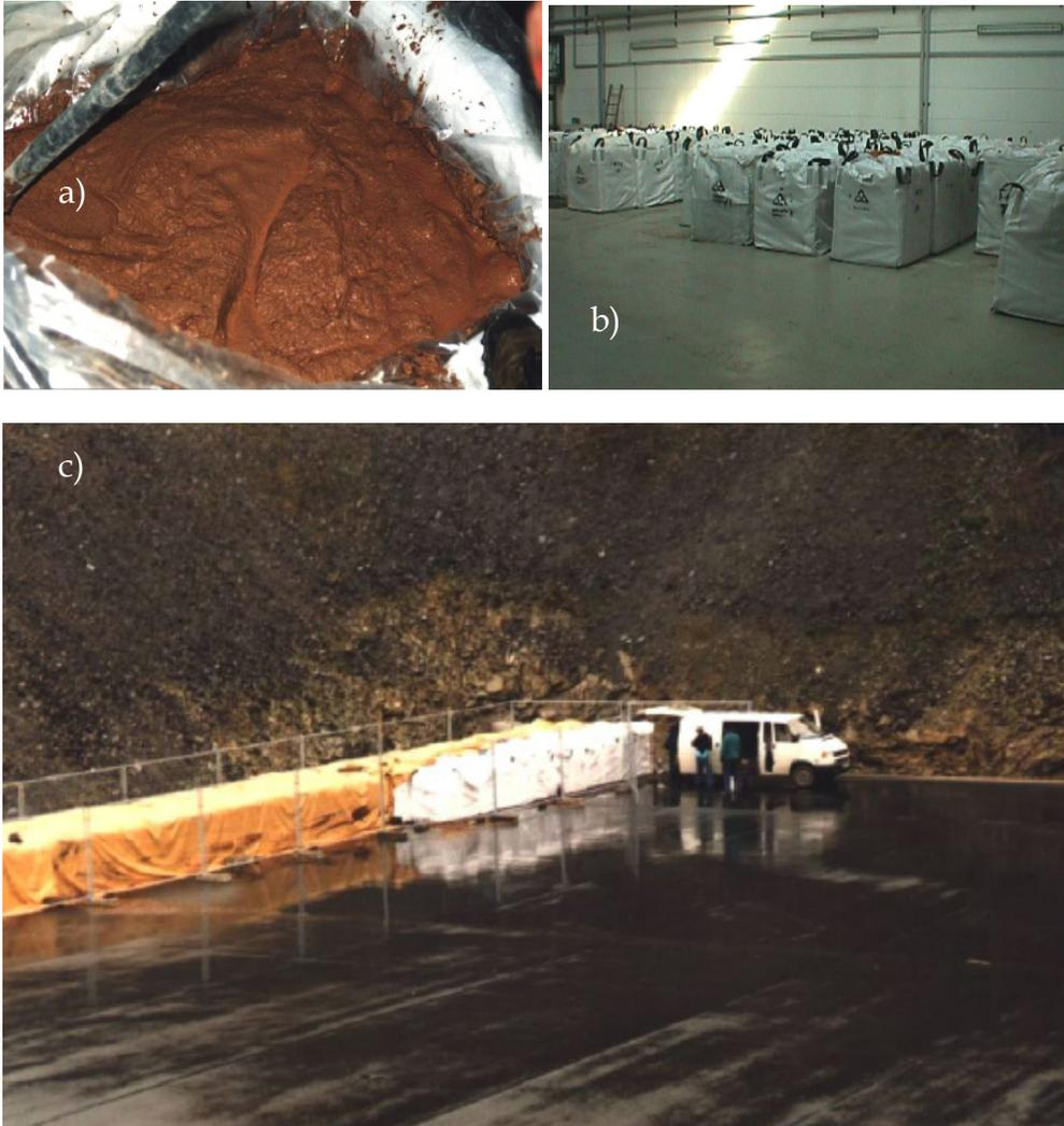
**Figura 6.1:** Imobilização de resíduos radioactivos: a) Mistura de ligante à base de resíduos; b) ligante endurecido em “big bags”; c) Colocação dos “big bags” em aterros (Hermann et al., 1999)
