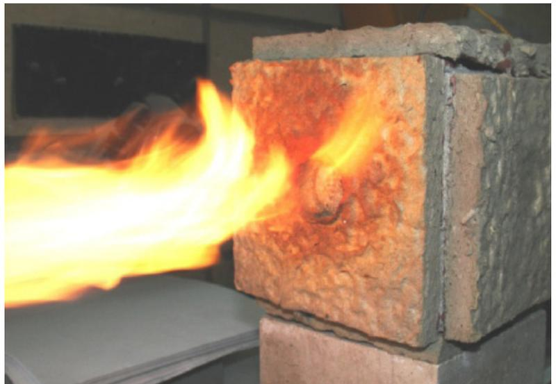
*Figura 4.4: Resistência ao fogo de placas de betão activado alcalinamente (Krivenko e Guziy, 2007)*
