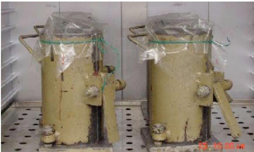
Figura 2.8: Selagem dos provetes com película plástica (Sumajow e Rangan, 2006)
