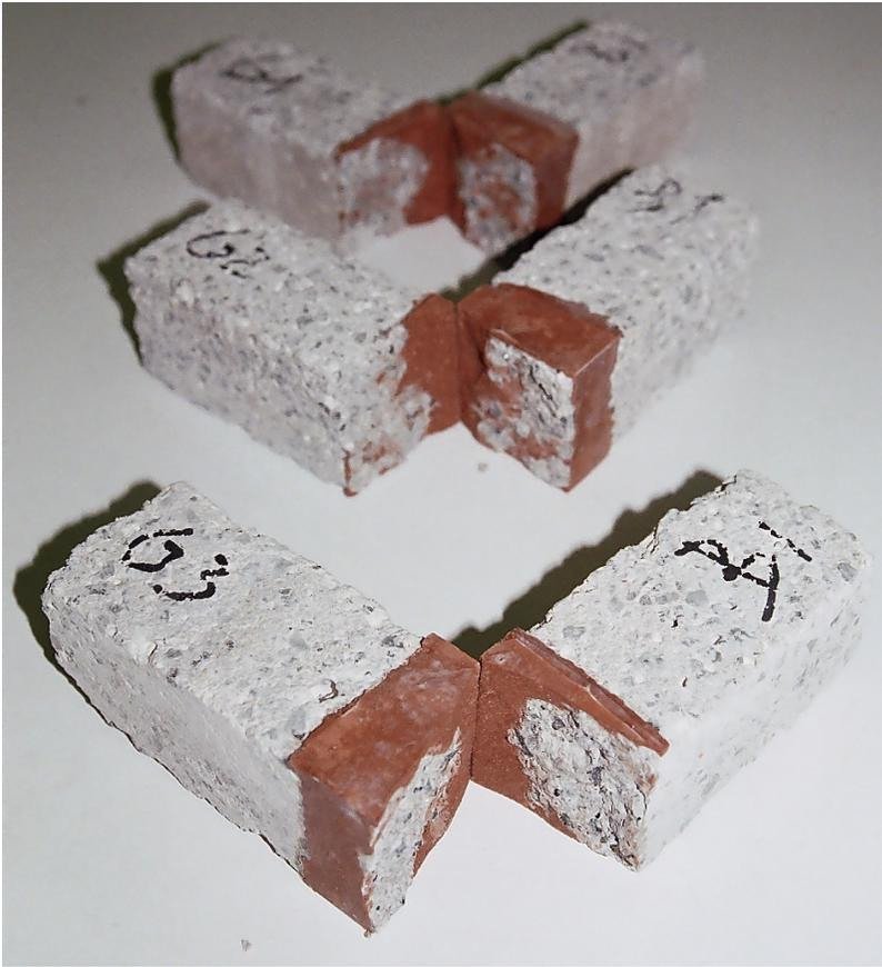
**Figura 3.12:** Aderência entre betões correntes e argamassas activadas alcalinamente. Pormenor da zona de fractura (Torgal *et al.*, 2006)
