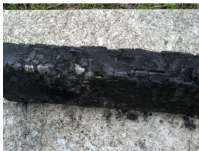
Figura 7 – Bloco de madeira (abeto) exposta ao fogo.
