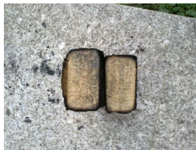
Figura 7 – Bloco de madeira (abeto) exposta ao fogo.
