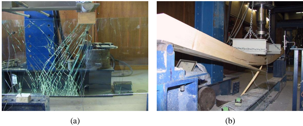
Figura 40 – Modos de rotura obtidos na Fase 1: (a) Viga de vidro; (b) Viga M04.
