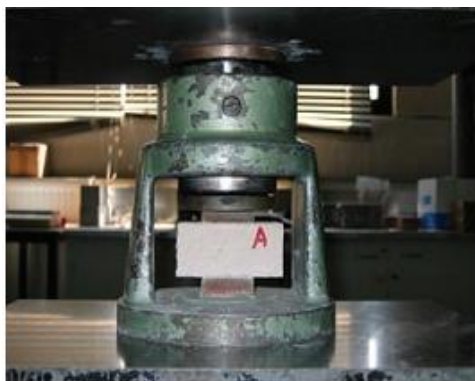
Fig. 7 - Ensaio à compressão a betonilhas. Imagem captada nos laboratórios do CSTB (Centro Científico e Técnico de Pavimentos) em França respeitando as normas EN13892-1-2 para betonilhas.
