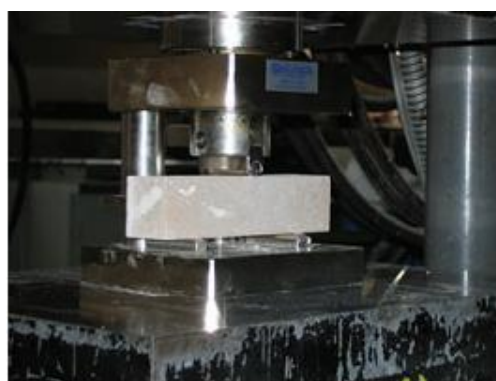
Fig. 6 - Ensaio à Flexão. Imagem captada nos laboratórios do CSTB (Centro Científico e Técnico de Pavimentos) em França respeitando as normas EN13892-1-2.
