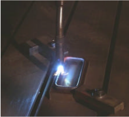
Fabrication d'une forme rectangulaire par soudage robotisé
