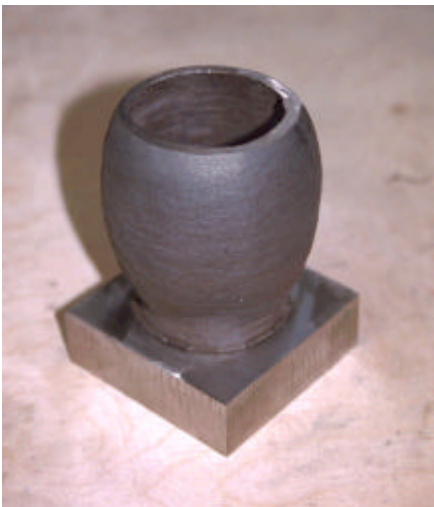
Pièce issue directement de la fabrication, sans post-traitement
