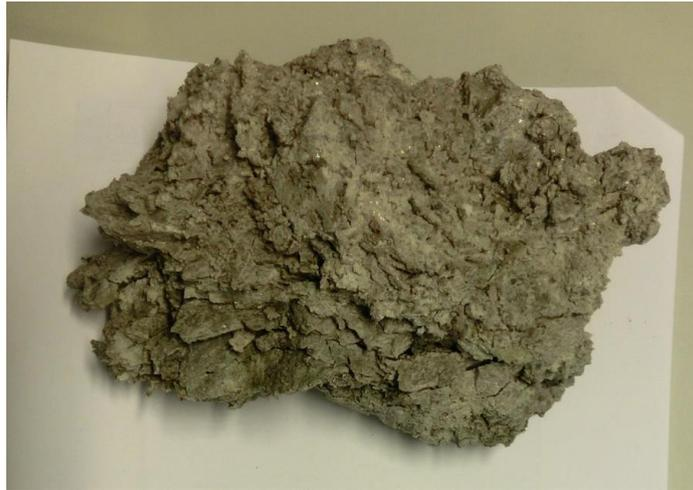
Figura 24 - Material da caixa de falha nº25 (brecha milonítica, argilosa)
