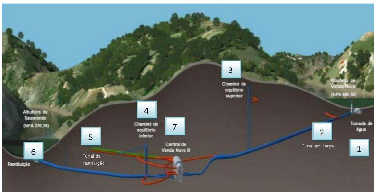
Figura 14 – Representação (sem escala) do Circuito Hidráulico de Venda Nova III e sua constituição (EDP, 2009).
