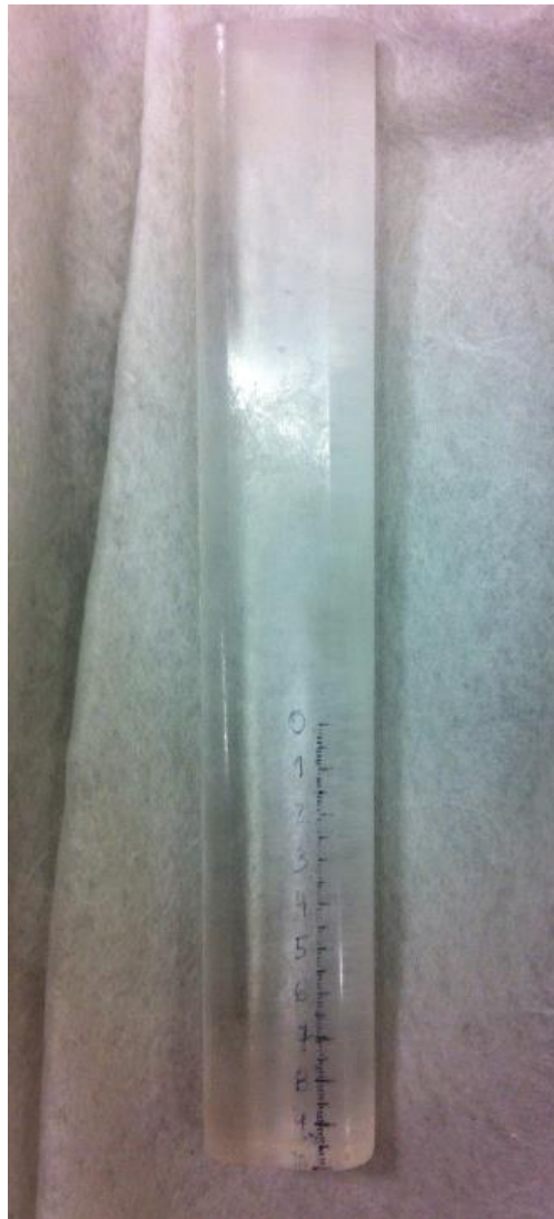
Figura 3.8: Marcação do pilar
