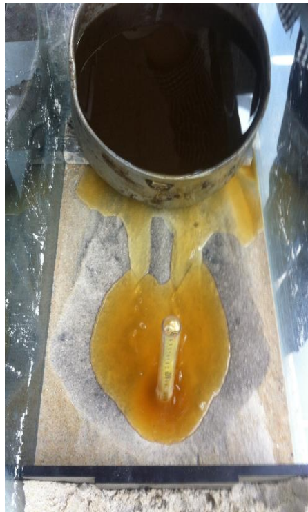
Figura 3.11: Exemplo da colocação da mistura de parafina e vaselina para a extração do molde
