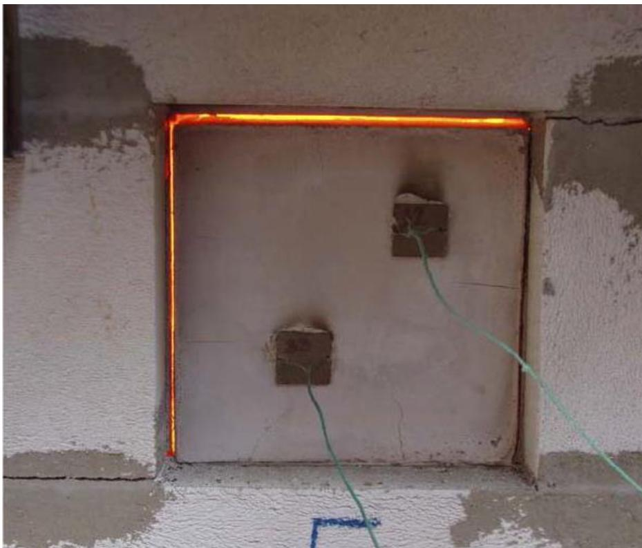
**Figura 2.11 - Placas obtidas por ativação alcalina (geopolímero) sujeitas a fase térmica [14]**
