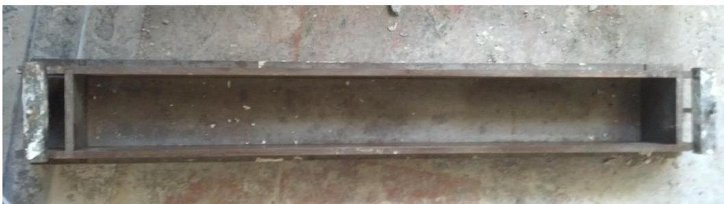
**Figura 3.11 - Molde paralelepípedo (100×100×850) (mm<sup>3</sup>)**
