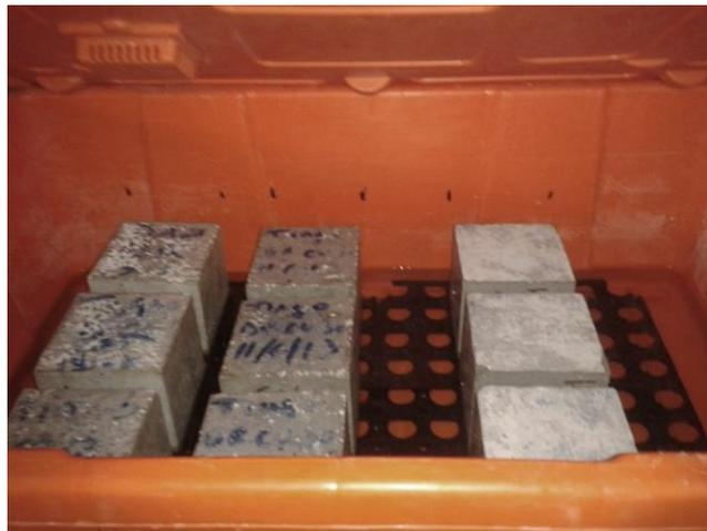
**Figura 3.14 - Provete submetidos ao ensaio de absorção de água por capilaridade**
