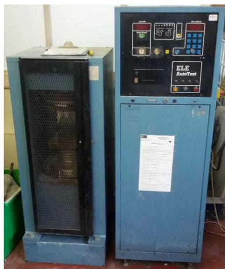
**Figura 3.12 - Máquina para ensaio de compressão**
