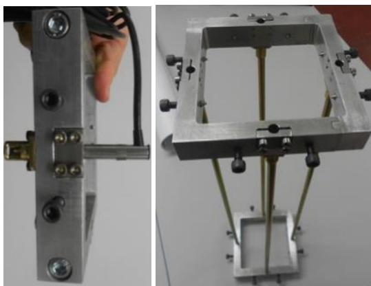
Figura 4.21- Pormenor da fixação dos LVDTs e sistema de fixação total
