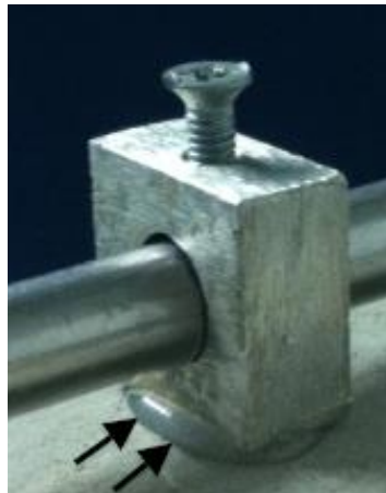
Figura 4.16- Deslocamento provocado pela retração da cola quente
