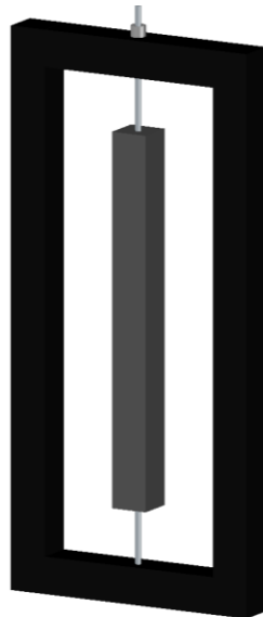
Figura 4.27- Sistema de ensaio para ancoragem do varão ao pórtico pelo uso de porcas
