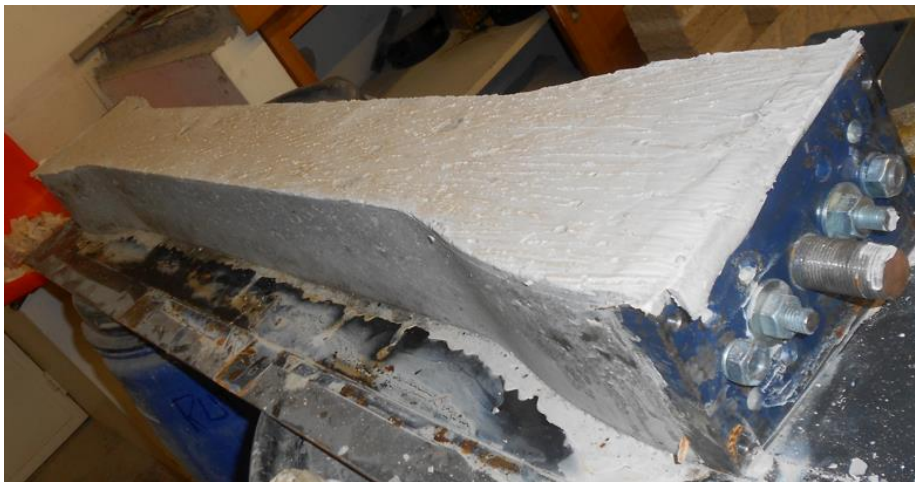
Figura 4.4- Provete resultante da utilização do novo molde
