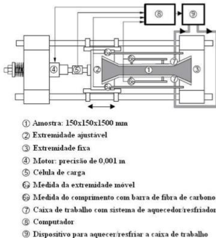
Figura 2.6- Sistema de ensaio desenvolvido por Springenschmid et al. (1994)
