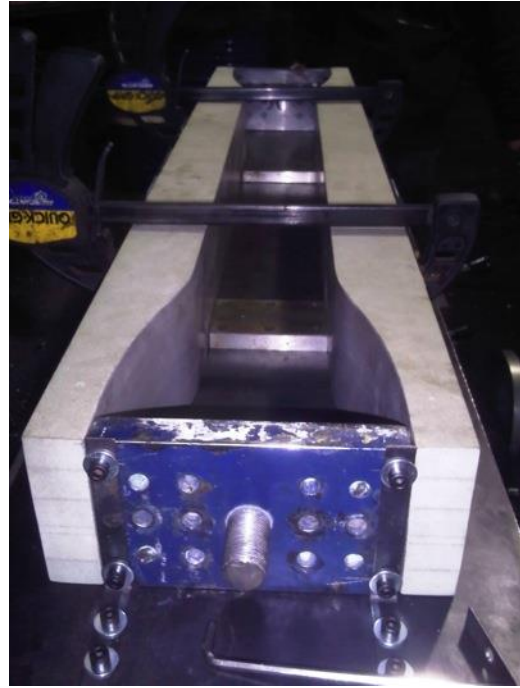
Figura 4.3-(a) Pormenor da ligação da chapa de topo à chapa de base; (b) molde do provete VRF em fase de construção
