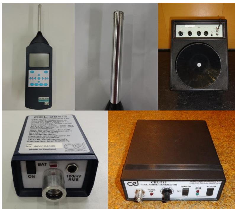
Figura 32 – Equipamentos – Sonómetro, Microfone e pré-amplificador, Fonte sonora, Calibrador acústico e Gerador de Ruído.
