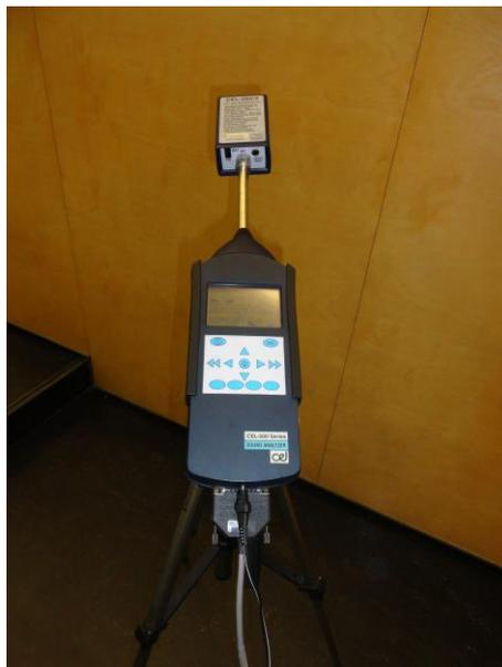
Figura 33 – Calibração do sonómetro.
