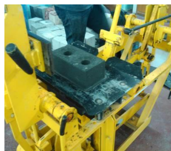
Fig. 3 – Fabrico de um BTC na prensa Terstaram.
