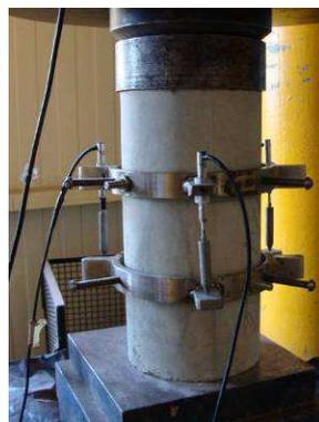
Figura 1. Ensaio de determinação do módulo de elasticidade
