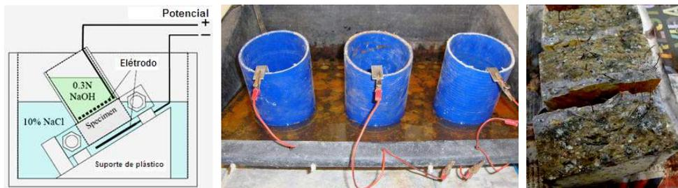
Figura 10. Ensaio acelerado de migração de cloretos
