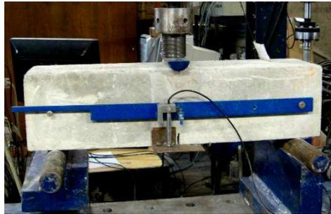
Figura 4. Ensaio de avaliação do comportamento à flexão
