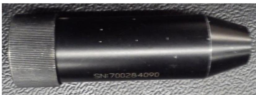
Figura 2.2 - Cabeça ótica do laser
