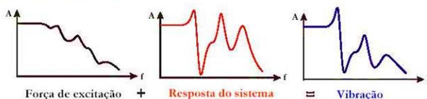
Figura 2.8 – Obtenção dos modos de vibração[15]
