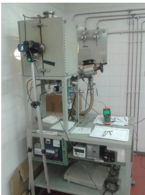
Figura 3.5- Forno de alto-vácuo, Departamento de Física da Universidade do Minho, Guimarães.
