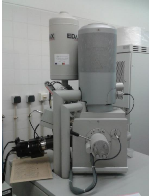
Figura 3.4- Microscópio Eletrônico de Varrimento (SEM) disponível no SEMAT, na Universidade do Minho, em Guimarães.
