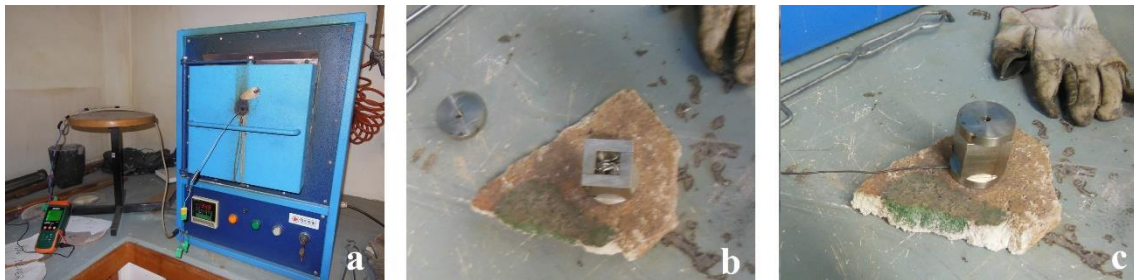
Figura 3.16- Preparação das amostras SAC305+Sn: a) Aquecimento do dispositivo até 300°C; b) Colocação do substrato, fluxo e solda SAC305; c) Arrefecimento ao ar.
