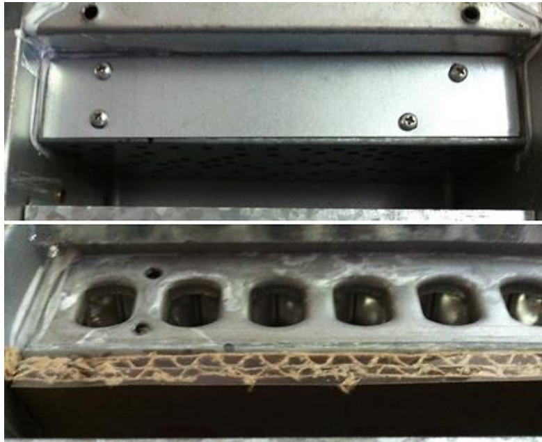
Figura 5.8 – Em cima, a entrada de ar primário bloqueada, em abaixo, a entrada de ar de secundário bloqueado
