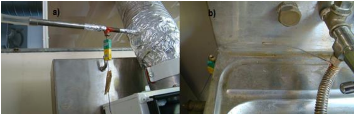
Figura 4.9 – a) Sonda de gases com ligação do termopar K e tubo para recolha de gases; b) termopar K ligado à água quente
