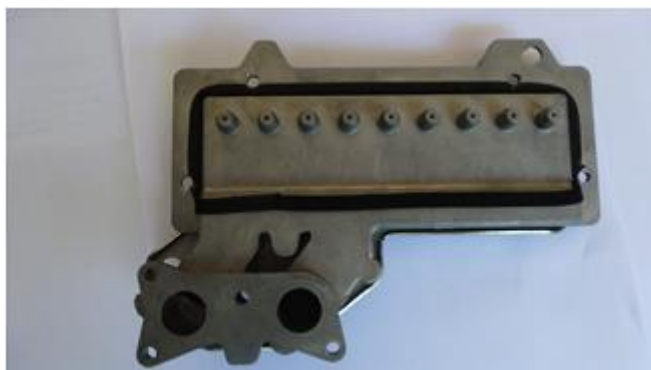
Figura 4.6 - Placa de distribuição do gás propano
