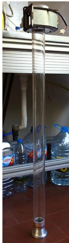
Figura 5.2 - Tubo com tubeira de 27 mm conectado ao ventilador
