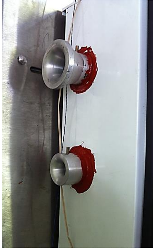
Figura 5.1 - Aplicação das tubeiras na lateral do esquentador, em cima de 27 mm abaixo de 15 mm
