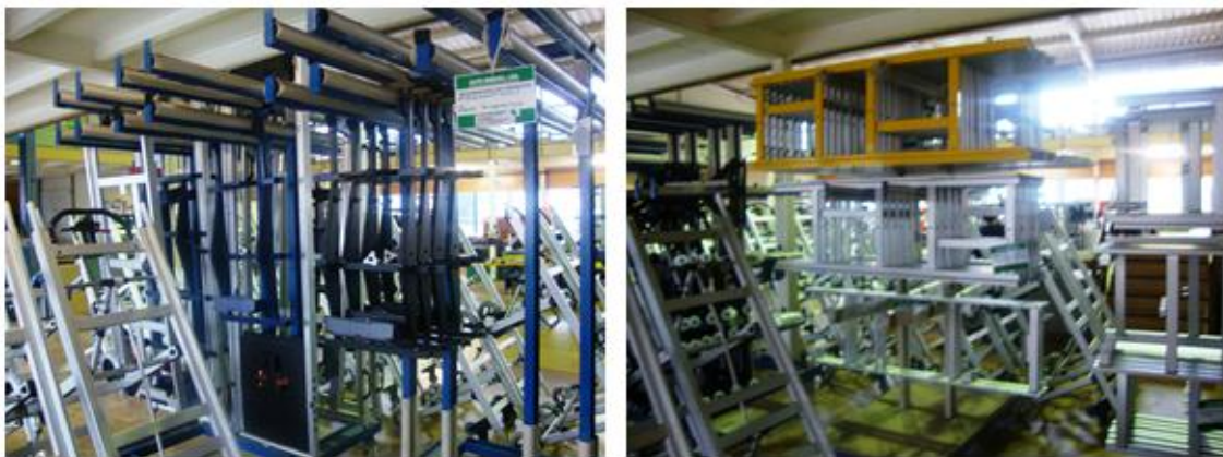
Figura 5-8: Estruturas para stock de serralharias
