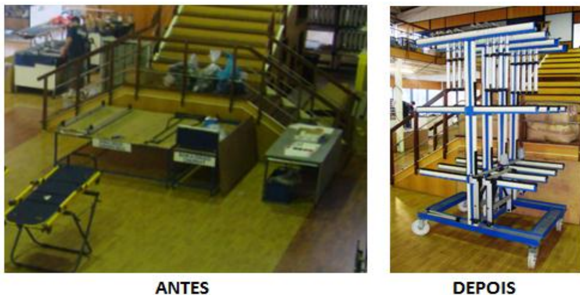
Figura 5-34: Substituição do local das Bancadas de Teste e Decoração pela estrutura de reposição de pernas e suportes articulados
