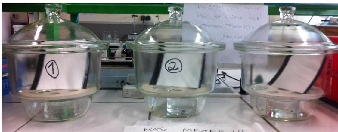
**Figura 11:** Método do Exsicador – fotografia de três réplicas durante um ensaio.
