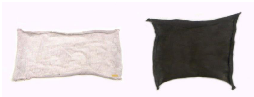
Figura 20 - Resultados do ensaio de coloração de lyocell cru sem quitosano e lyocell cru com 1% de quitosano, respectivamente.
