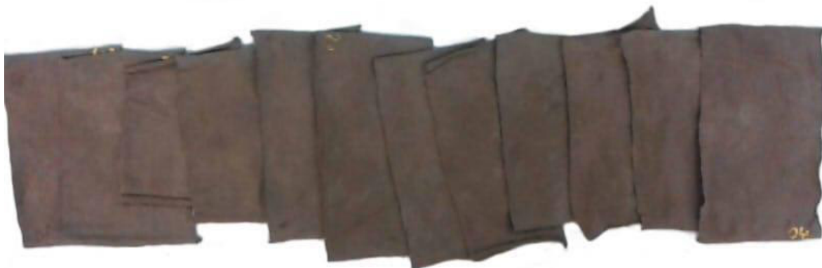
Figura 33 - Resultados do ensaio de coloração na MATHIS de algodão meio branco cationizado com 3% indosol.
