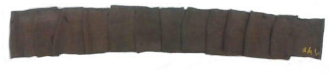
Figura 36 - Resultados do ensaio de coloração na MATHIS de algodão meio branco funcionalizado com 1% quitosano
