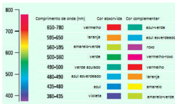
Figura 11 -Relação existente entre a cor observada pelo ser humano e a cor absorvida pelo objeto. Adaptado de (Owen, 2000).
