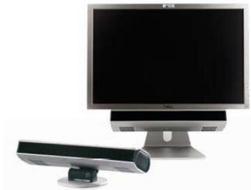
Figura 3.1: Apresentação de um ecrã de um computador e um eyetracker utilizado na experiência. O sistema de eyetracker analisa os respetivos movimentos oculares e está incorporado na parte inferior do monitor para cada participante fazer a leitura dos textos nas diferentes condições.
