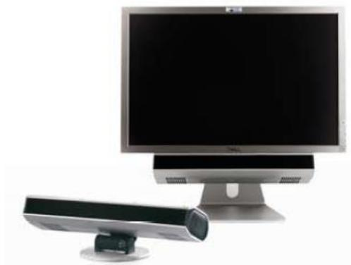
Figura 1.4: Sistema eyetracker incorporado a um monitor de computador. Este aparelho tem como uma das funções a avaliação dos movimentos oculares durante a leitura.
