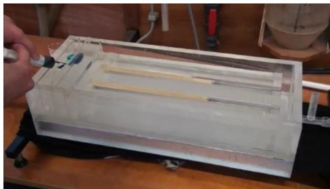
Figura 26 - Visualização do escoamento, chicana posicionada a 1cm, t=0
