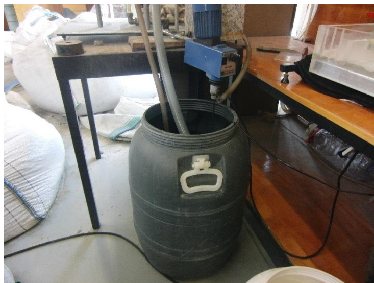
Figura 19 - Reservatório a montante da instalação experimental
