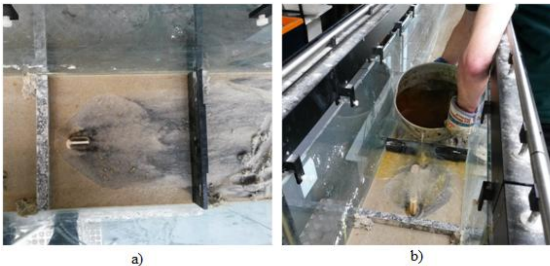
Figura 3.12 Levantamento tridimensional do molde (Colocação da cofragem (a); Enchimento da cavidade de erosão com vaselina e parafina (b))
