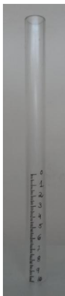
Figura 3.11 Régua milimétrica desenhada no pilar circular simples
