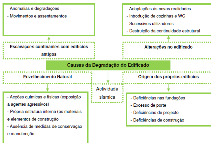
Figura 13 - Causas de degradação do edificado (Fonte: (25)).
