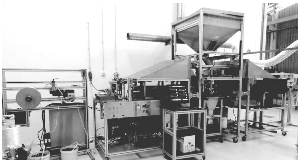
Figura 5.1: Equipamento de produção de towpregs utilizado.
