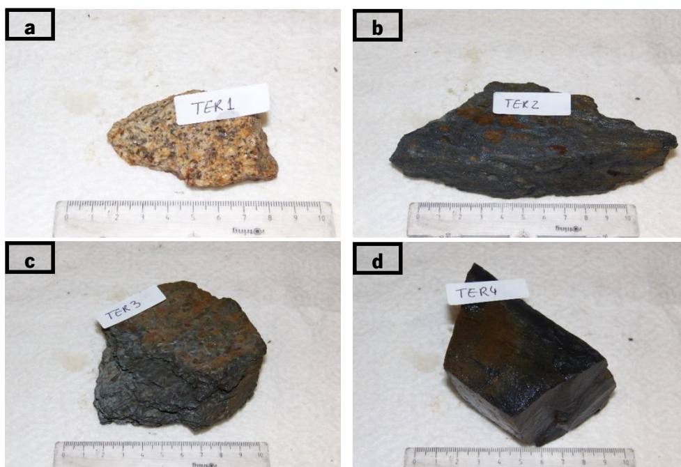
Figura II.34. Fotografias das amostras recolhidas em campo. a – Granito do local 16; b – Filito do local 18; c – Xisto mosqueado do local 22; d – Quartzito do local 23.
