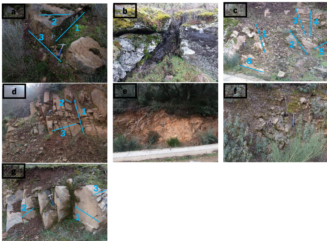
Figura II.33. Fotografias dos afloramentos nos locais 16 (a), 17 (b), 18 (c), 20 (d), 21 (e), 22 (f) e 23 (g) e, respectivas famílias de diáclases.
