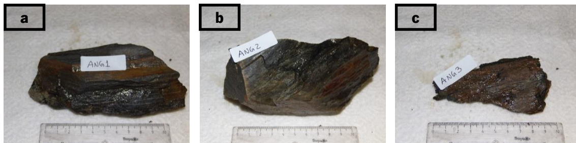
Figura II.39. Fotografias das amostras recolhidas em campo. a – Xisto do local 24; b – Quartzito do local 26; c – Xisto meteorizado do local 27;
