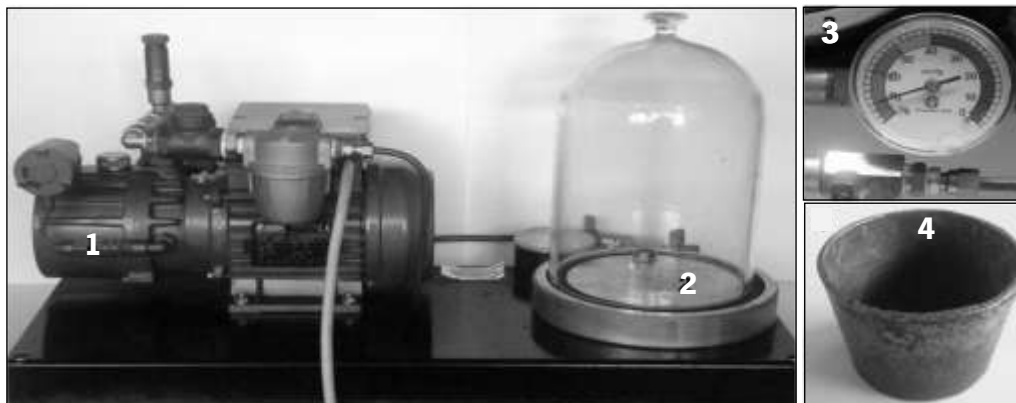
Figura 3.7 – Equipamento de teste RPT (Straub-Pfeiffer). 1 – Bomba de vácuo; 2 – Câmara de baixa pressão; 3 – Manómetro de pressão; 4 – Copo para vazamento do metal líquido.
