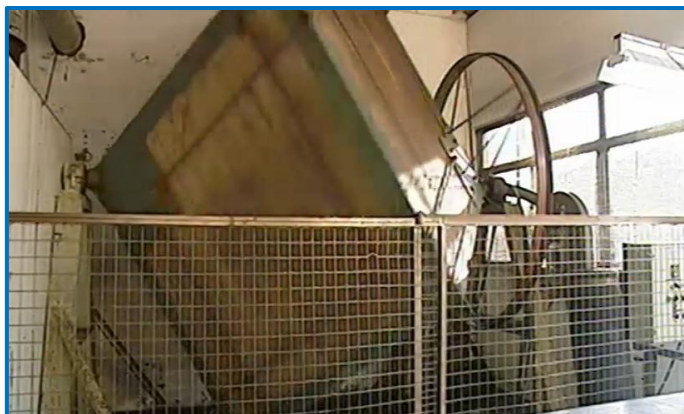
Figura 4.3 – Pisão têxtil adaptado para “destruir” a superfície das peles
