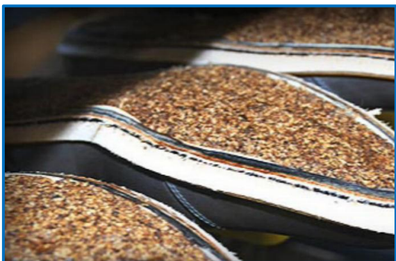
Figuras 4.9 – Construção Goodyear: operação de enfustar e rib.
