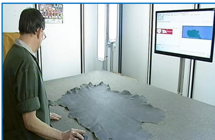
Figura 4.4 – Marcação das peles com sistema CAD
