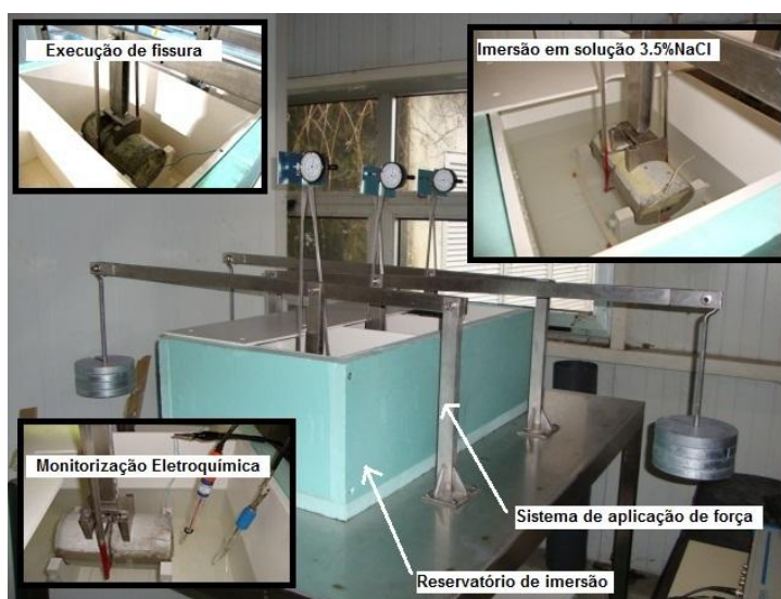
Figura 2: Imersão dos provetes fissurados sob tensão na solução
