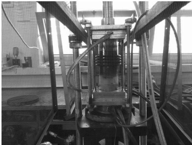
Figura 23- Detalhe da bobine de indução no equipamento de *hot-pressing*
