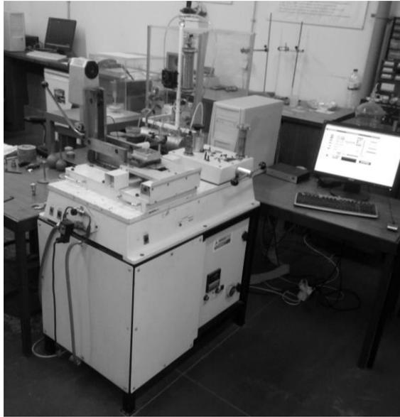
Figura 31- Vista geral do tribômetro Plint TE67-R utilizado para a realização dos testes tribológicos
