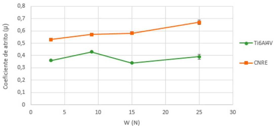
Figura 45- Valores médios do coeficiente de atrito em regime estacionário para o par compósito CNRE/alumina em função da carga aplicada em comparação com os valores de referência obtidos para o par Ti6Al4V/alumina
