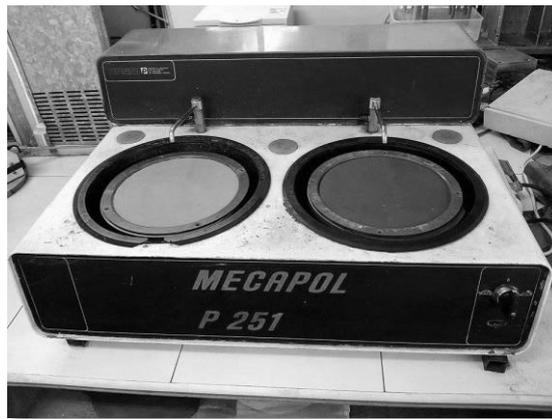
Figura 27- Equipamento de desbaste e polimento
