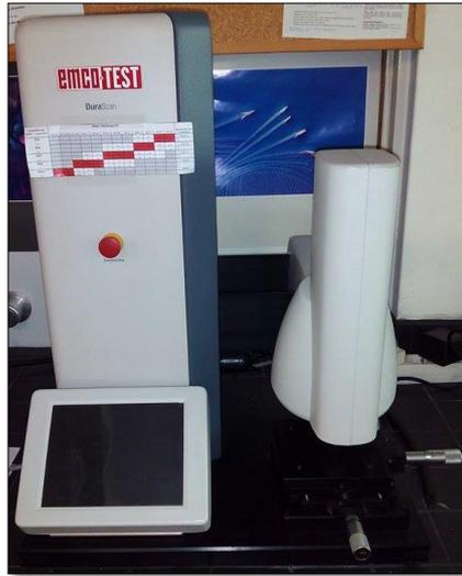
Figura 33- Equipamento utilizado nos testes de dureza
