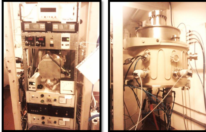
Figura 4.2 – Câmara de vácuo utilizada nas deposições. A foto da esquerda representa a vista frontal e a da direita representa a vista lateral-direita.
