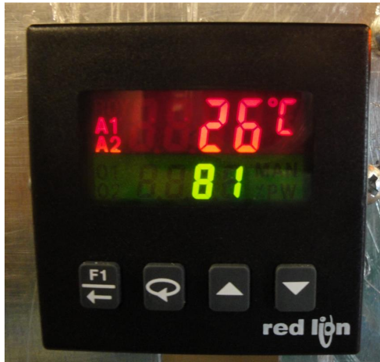
Figura 5.6 – Controlador de temperatura T16 – Temperature Controller , da Red Lion Controls Inc .
