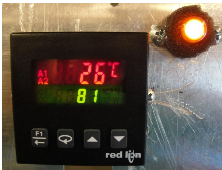
Figura 5.11 – Controlador PID e lâmpada de aviso, com as lâmpadas de aquecimento ligadas.
