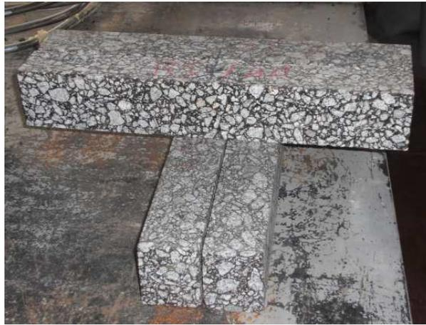
**Figura 33 – Vigas colocadas para simular uma fenda vertical ocorrida por baixo do pavimento (separação das vigas inferiores: 5 mm).**
