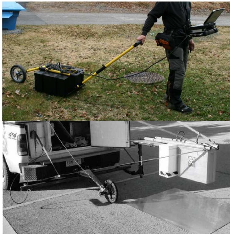
**Figura 1 - Exemplo de antena GPR de contacto com a superfície (em cima) e suspensa (em baixo)**
