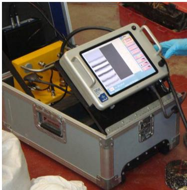
**Figura 29 – Foto do equipamento utilizado: unidade de controlo, monitor e antena de 1.6GHz.**
