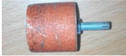
Figura 47 – Cilindro de madeira com lixa para desgaste das imperfeições do modelo
