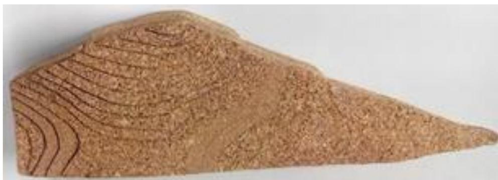
Figura 45 – Parte do modelo físico colado com cola de contacto
