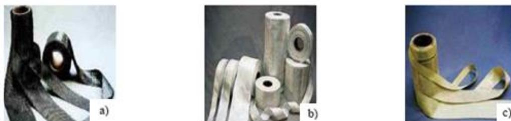
Figura 2.5 - Aspeto visual de diferentes tipos de fibra: a) Fibra de Carbono b) Fibra de Vidro c) Fibra de Aramida (adaptado de Sousa, 2008)
